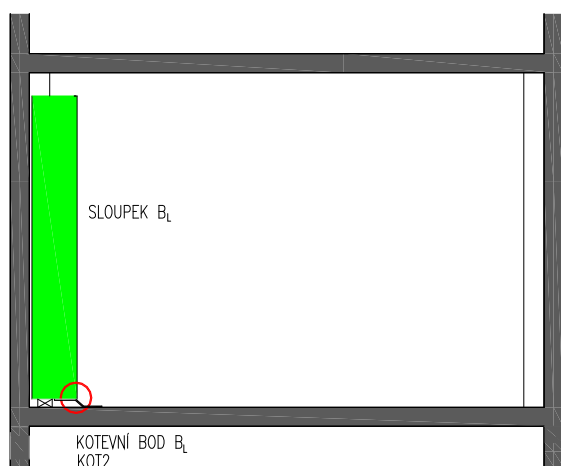
Obrázek 6: Postup montáže lodžiové stěny – sloupek B_L
